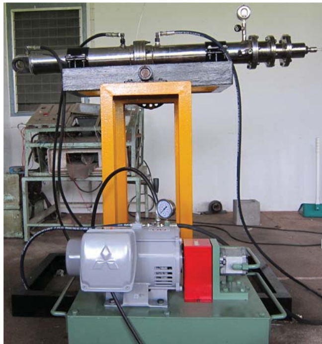
รูปที่ 6.1 ชุดต้นแบบของอุปกรณ์นำส่งยาด้วยลำพุงความเร็วสูง Med-jet NFIS
