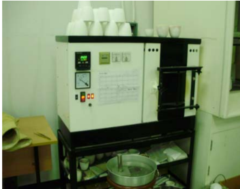
รูป 3.4 เตาเผาไฟฟ้า (electric furnace) ที่ใช้ในการหลอมแก้ว
