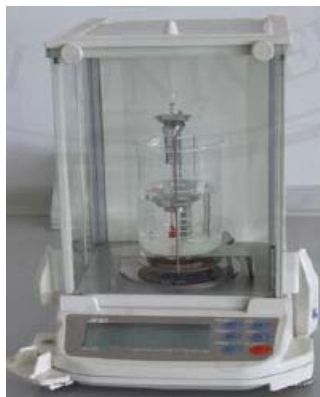
รูป 3.11 เครื่องชั่งระบบดิจิตอลสำหรับวัดความหนาแน่น
