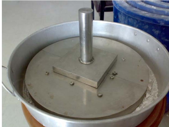
รูป 3.7 แผ่นเหล็กกล้าไร้สนิม (stainless steel plate) สำหรับกดทับแก้ว
