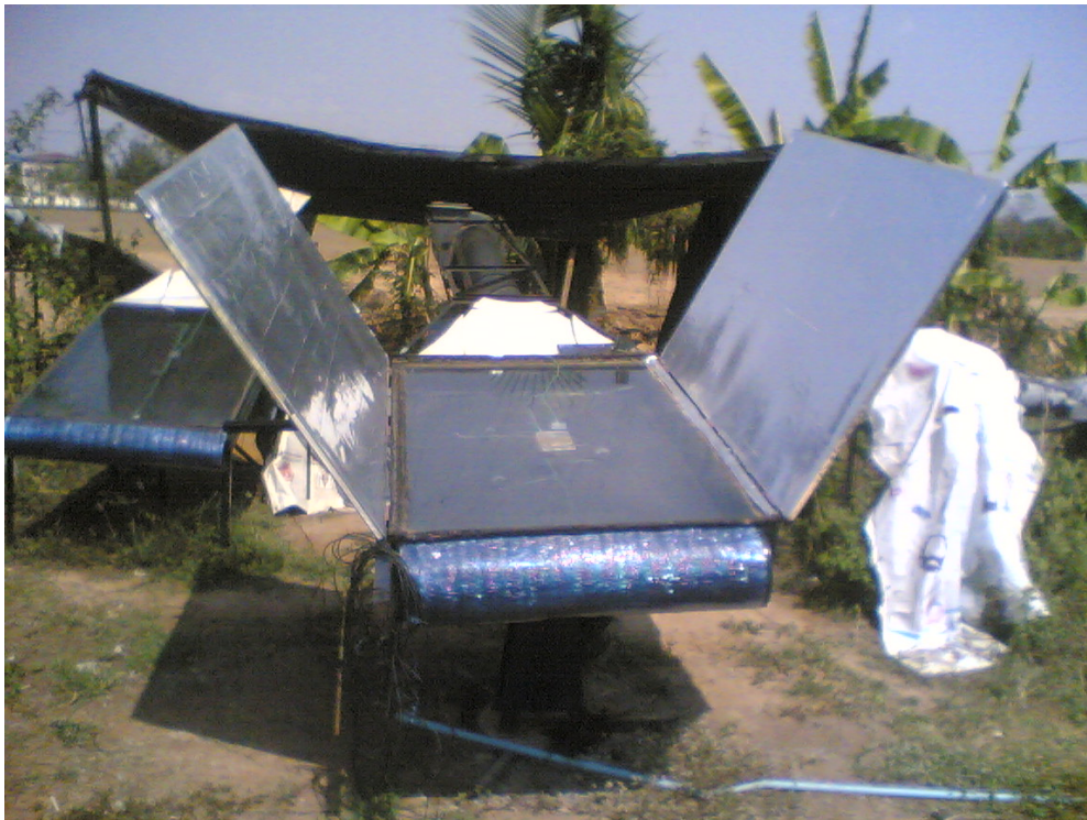
รูปที่ 2 ภาพถ่ายตัวเก็บรังสีอาทิตย์แบบผสมความร้อนไฟฟ้าเทอร์โมอิเล็กทริกพร้อมกับตัวรวมรังสีอาทิตย์
