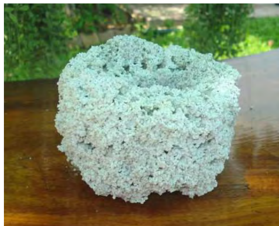
รูปที่ 54 การหลอมตัวของอนุภาคเบดรวมกับเถ้าเชื้อเพลิงที่อัตราการป้อนเชื้อเพลิง 15 kg/h
