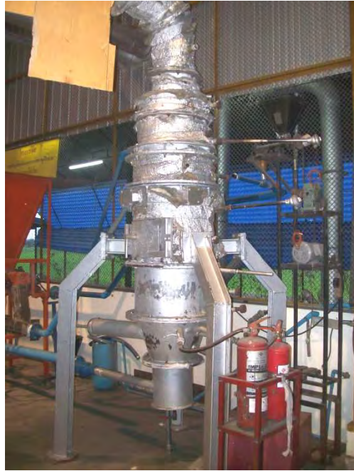
รูปที่ 16 เตาเผาไหม้วอร์เทค-ฟลูอิดไธเซเบตขนาดพิกัด 100 kW th ที่ใช้สำหรับทดลอง
