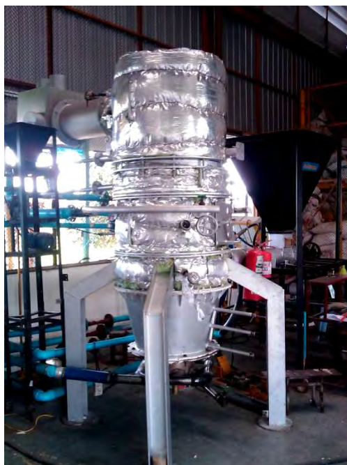
รูปที่ 1 เตาเผาไหม้ฟลูอิดไธซ์เบดแบบห้องเผาไหม้สั้น (SFBC) ขนาดพิกัด 250 kW th
