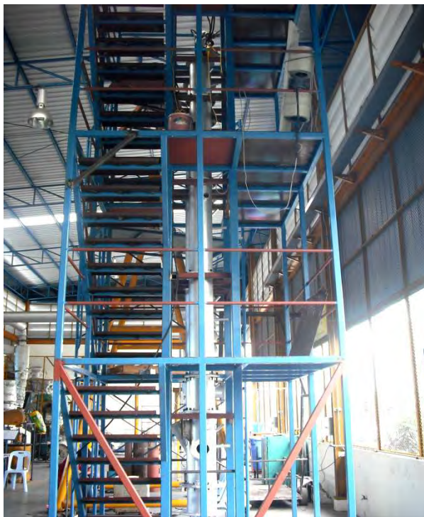
รูปที่ 40 เตาเผาไหม้ฟลูอิดไธด์เบดแบบหมุนเวียนขนาดพิกัด 50 kW th ที่ก่อสร้างขึ้นสำหรับทดลอง
