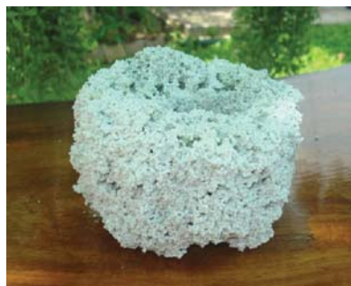
รูปที่ 7 การหลอมตัวของอนุภาคเบดรวมกับเถ้าเชื้อเพลิงที่อัตราการป้อนเชื้อเพลิง 15 kg/h
