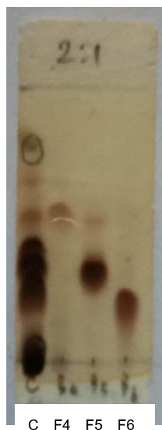
รูปที่ 1 รูปแบบที่แตกต่างกันบน thin-layer chromatography ด้วยระบบ hexane/EtOAc (2:1) ของ crude extract (C) และ fractions ต่าง ๆ (F4, F5 and F6) ทดสอบด้วย vanillin reagent.
