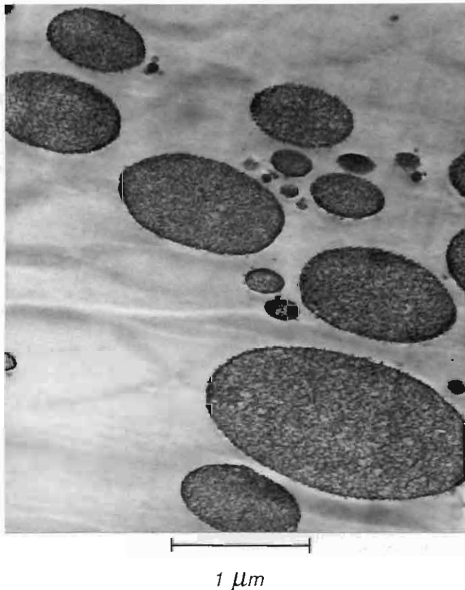
รูป 3.6 : TEM แสดง morphology ของ polystyrene (PS) ที่มี RVNR particles (14kGy) หลังจากใช้ phase transfer/ bulk polymerisation (1%BPO, 70^{\circ}\text{C} 18h)
