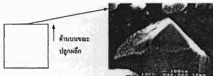
รูปที่ 2. 5 แสดงผลึกที่เกิดขึ้นที่บริเวณขอบบนของตัวอย่าง 13 ซึ่งเป็นผลึกทรงเหลี่ยมแปดหน้าที่เกิดจากผลึกเล็กๆ (nanocrystalline)
