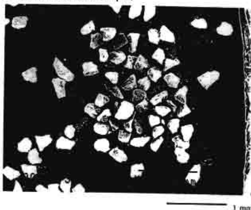
รูปที่ 6 ภาพถ่าย SEM ของผงเซรามิกที่ผ่านการบด-ร่อนค้ำระหว่างตะแกรงในลอนเบอร์ 28 และ 36 (ผงสาร size 4 ขนาดประมาณ 168-181 \mu\text{m} )
