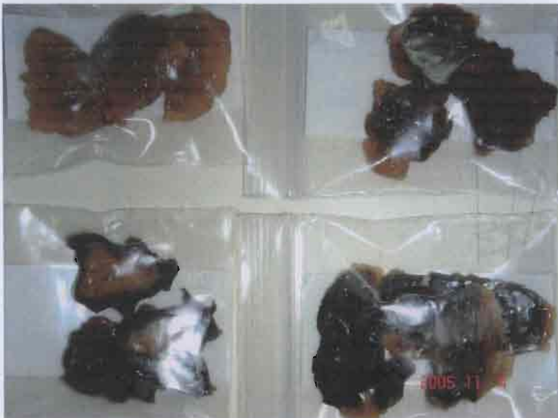
รูป 4.24 อิทธิพลของเกล็ดต่ออย่าง admicellar polymerization เตรียมที่ภาวะเดียวกับรูป 4.22 เมื่อมี [สไตรีน] 100 mM ไม่มีเกล็ด มีเกล็ด 0.1 0.3 และ 0.6 mM
