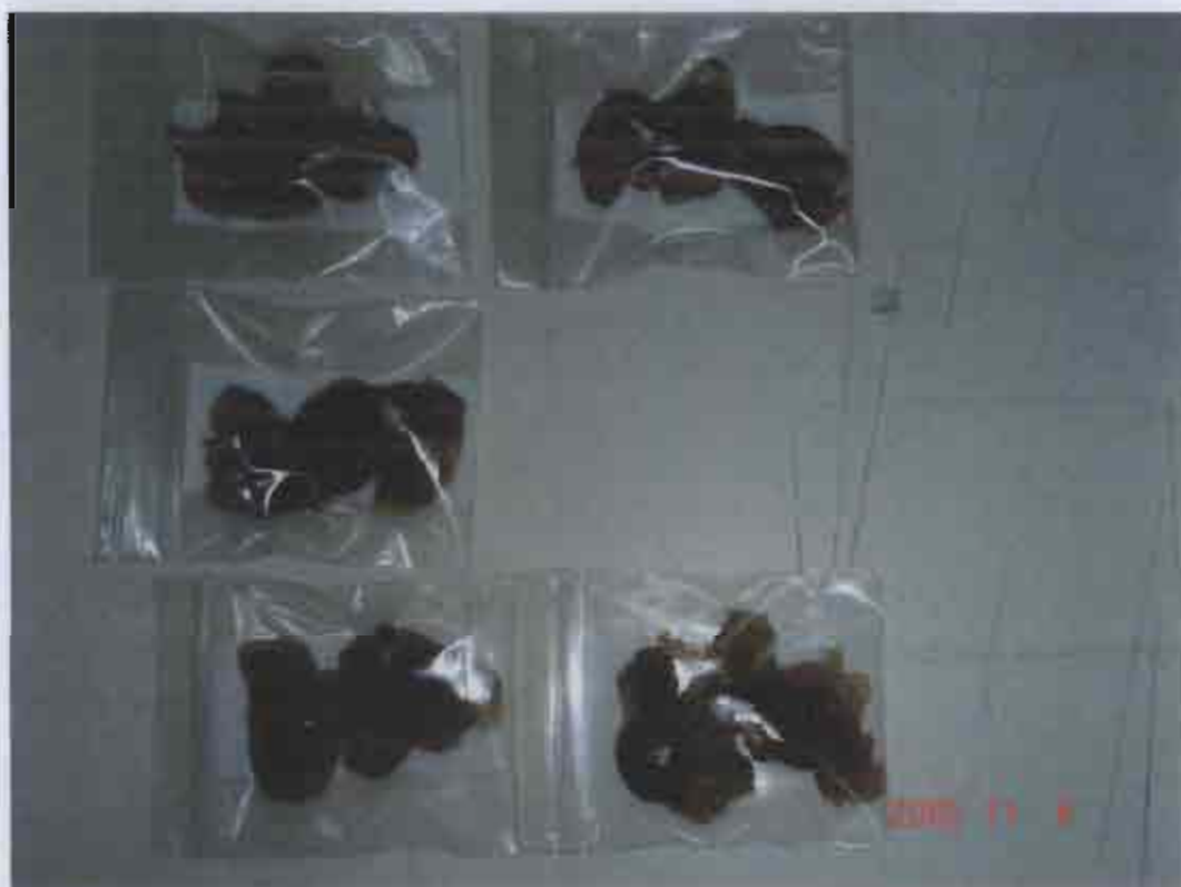
รูป 4.23 ตัวอย่างที่ได้จาก admicellar polymerization ของสไตรีนที่ความเข้มข้นต่างๆ (30-200 mM) ที่สัดส่วนสไตรีนต่อแอมโมเนียมเปอร์ซัลเฟต (2:1) ปริมาณยาง 4 g ใน 20 ml และ [SDS] 24,000 \mu M
