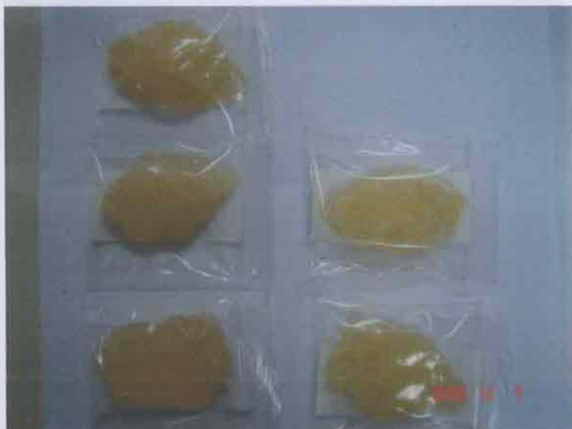
รูป 4.25 ยาง admicellar polymerization ของสไตรีนที่ความเข้มข้นต่างๆ (30-200 mM) โดย AIBN เมื่อให้สัดส่วน สไตรีน: AIBN 20:1 ปริมาณยาง 4 g ในปริมาตร 20 ml [SDS] 24.000 \mu M
