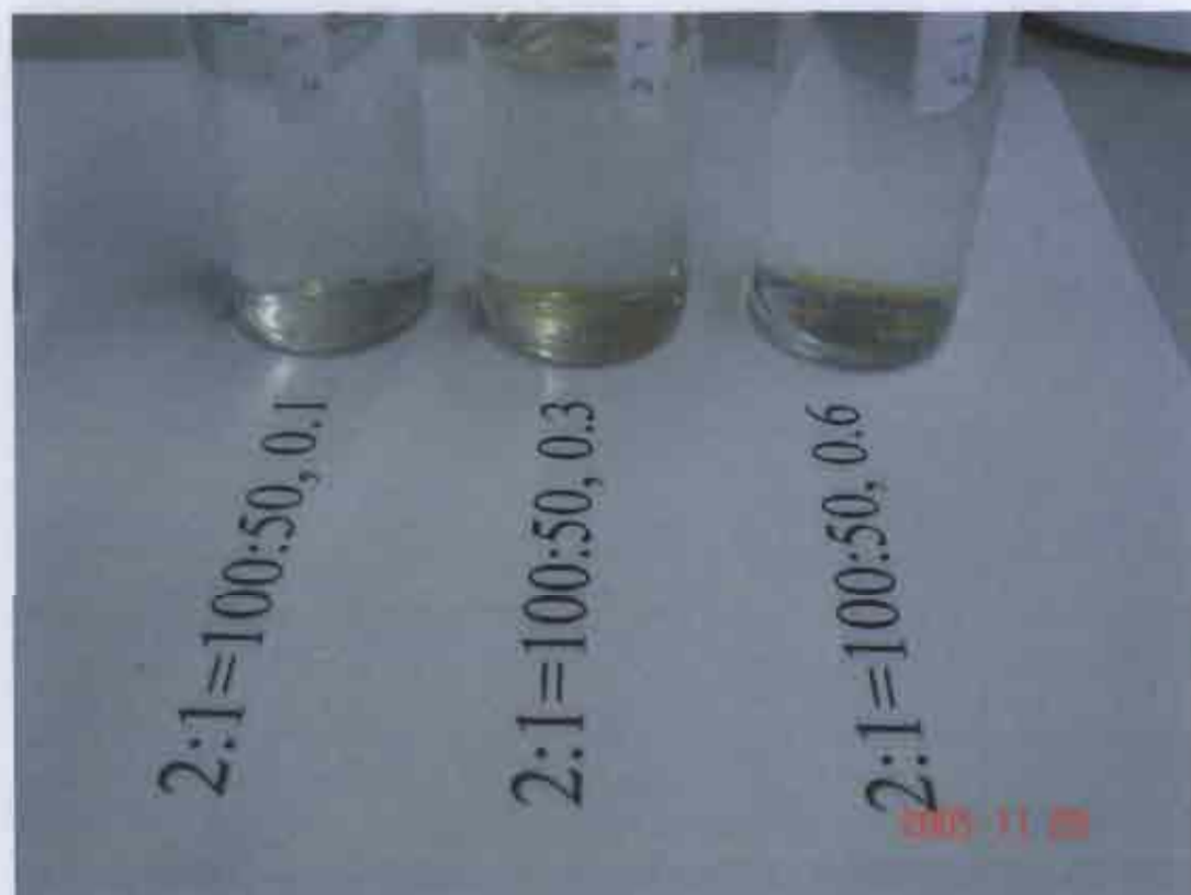
รูป 4.25 แสดงความสามารถในการละลายในโทลูอีนของยาง admicellar polymerization ของสไตรีนจากรูป 4.22-4.23 (บน) ตัวอย่างทั้งหมด (ล่าง) ตัวอย่างที่มีเกลือ 0.1 0.3 และ 0.6 mM
