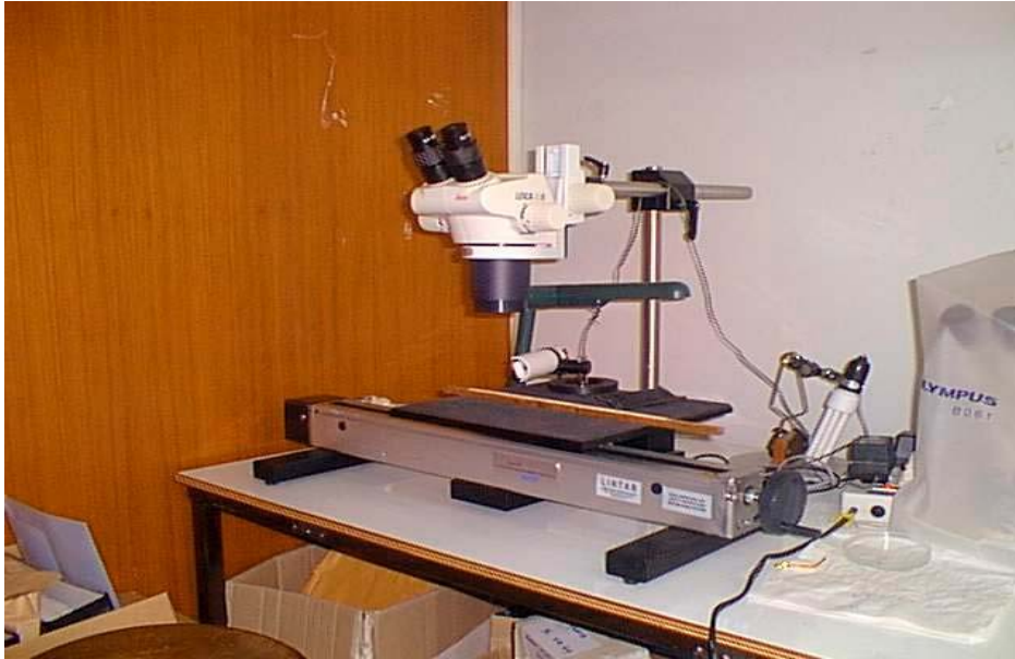
รูปที่ 3-12 อุปกรณ์เครื่องมือวัดขนาด/นับจำนวนวงปี ต่อตรงเข้ากับชุดคอมพิวเตอร์
