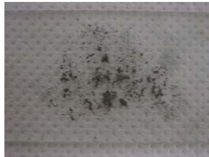
รูปที่ 8 ปลีแม่เหล็กที่มีสภาพผิดปกติ
