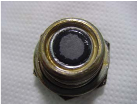
รูปที่ 6 ปลั๊กแม่เหล็กที่ล้างด้วยโซลเว้นท์แล้ว
