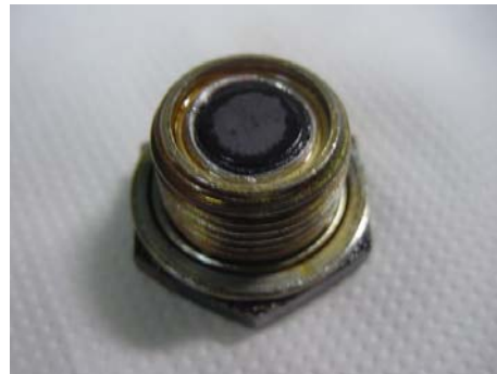
รูปที่ 6 ปลั๊กแม่เหล็กที่ล้างด้วยโซลเว้นท์แล้ว
