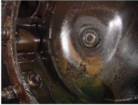
รูปที่ 3 ตำแหน่งของปลั๊กแม่เหล็กที่ชุดเฟืองท้าย
