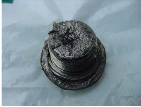
รูปที่ 8 ปลีแม่เหล็กที่มีสภาพผิดปกติ
