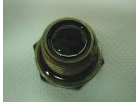
รูปที่ 5 ปลั๊กแม่เหล็กที่ถอดออกมาวิเคราะห์
