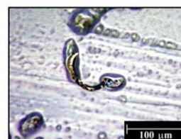
รูปที่ 5 ลักษณะผิวรอยสีกหรอและเศษโลหะของร่องสีนกรณีที่ 3
