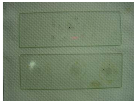
รูปที่ 6 ปลั๊กแม่เหล็กที่ล้างด้วยโซลเว้นท์แล้ว
