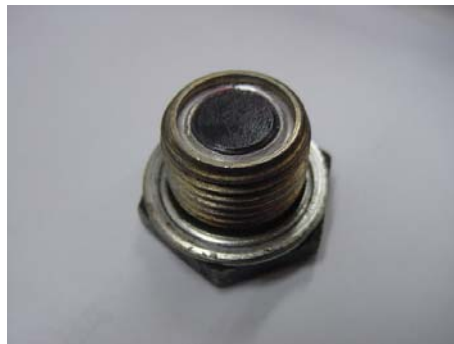
รูปที่ 4 ลักษณะของปลั๊กแม่เหล็ก
