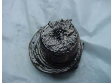
รูปที่ 8 ปลีแม่เหล็กที่มีสภาพผิดปกติ
