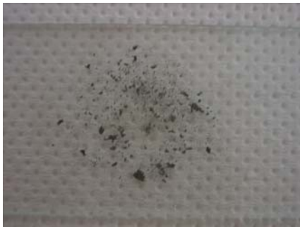
รูปที่ 8 ปลีแม่เหล็กที่มีสภาพผิดปกติ
