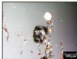
รูปที่ 4 ลักษณะผิวรอยสีกหรอและเศษโลหะของร่องสีนกรณีที่ 2
