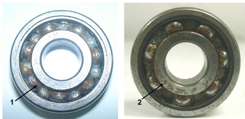
รูปที่ 2 ร่องลื่นหลังจากแกะฝาซีลออก
