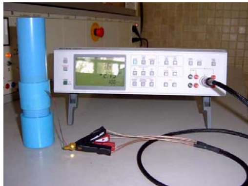
รูปที่ 7 ภาพการต่ออุปกรณ์วัดคาปาซิแตนซ์ RCL Meter กับอุปกรณ์
