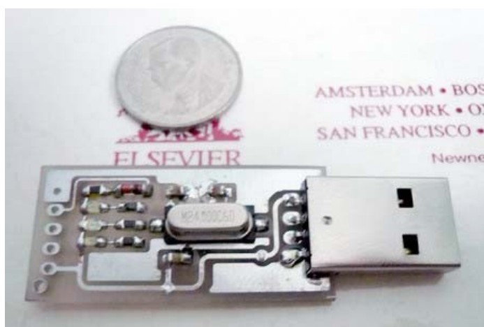
รูปที่ 57 ต้นแบบอุปกรณ์ Hard Lock ในส่วนของการเข้ารหัสภาพเทียบกับเหรียญบาท
