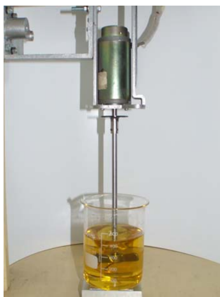
รูปที่ 61 แผนภาพหลักการทำงานของวงจรอลวนสำหรับเครื่องปั่นผสมไบโอดีเซลสำหรับห้องปฏิบัติการ
