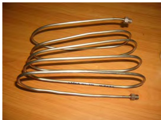
รูปที่ 4.9 แก๊สตัวอย่างและคอลัมน์ที่ใช้วิเคราะห์แก๊ส
