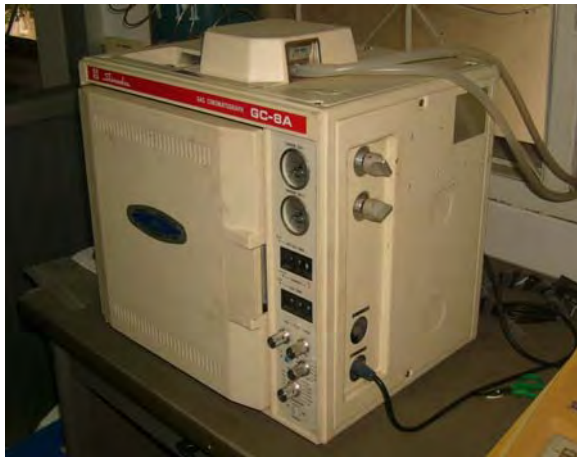
รูปที่ 4.8 ลักษณะของเครื่อง GC และเครื่องพิมพ์ที่ใช้วิเคราะห์แก๊ส
