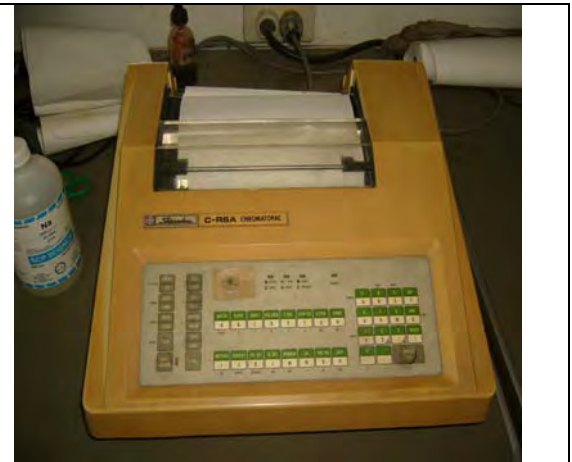
รูปที่ 4.8 ลักษณะของเครื่อง GC และเครื่องพิมพ์ที่ใช้วิเคราะห์แก๊ส
