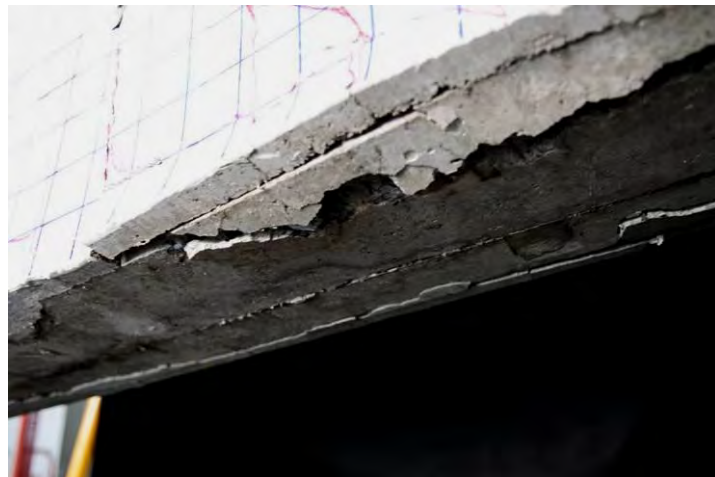
รูปที่ 4.20 การวิบัติของเหล็กเดือยในคานเสริมกำลัง
