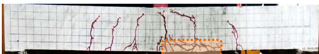
รูปที่ 5.29 รูปแบบรอยร้าวของตัวอย่าง 00C2
