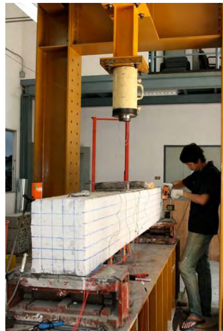
รูปที่ 4.12 การติดตั้ง LVDT และการตั้งกล้องเพื่อบันทึกภาพการเคลื่อนตัวของชั้นทดสอบ
