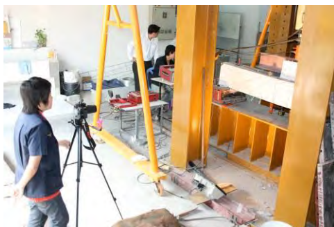
รูปที่ 4.12 การติดตั้ง LVDT และการตั้งกล้องเพื่อบันทึกภาพการเคลื่อนตัวของชั้นทดสอบ
