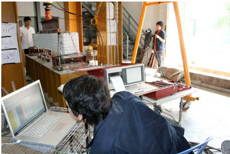
รูปที่ 4.15 การติดตั้งเครื่องมือวัดเข้ากับ data logger
