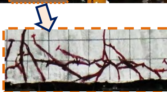
รูปที่ 5.30 รูปแบบรอยร้าวของตัวอย่าง 20F0
