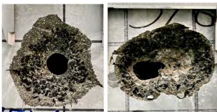
รูปที่ 4.6 การวิบัติแบบกระเทาะออก+ทะลุผ่านของแผ่นคอนกรีต 2 ชั้นที่มีชั้นคอนกรีตผสมเม็ดขนาดหนา
