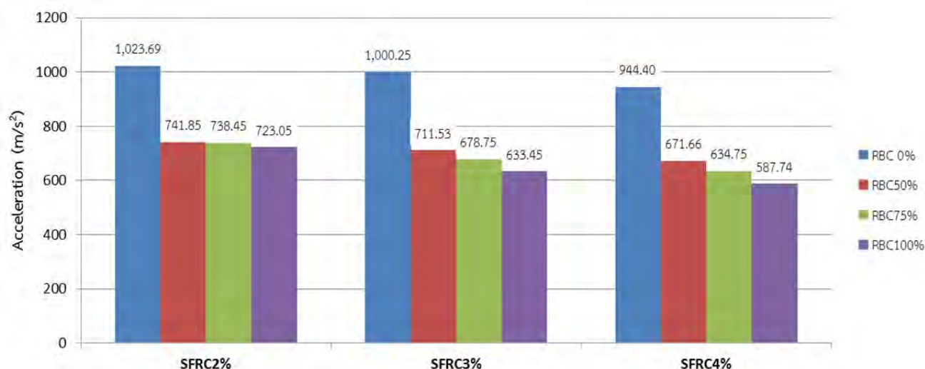
รูปที่ 4.15 อัตราเร่งของแผ่นคอนกรีตภายใต้แรงกระแทกของกระสุนขนาด 9 มม.
