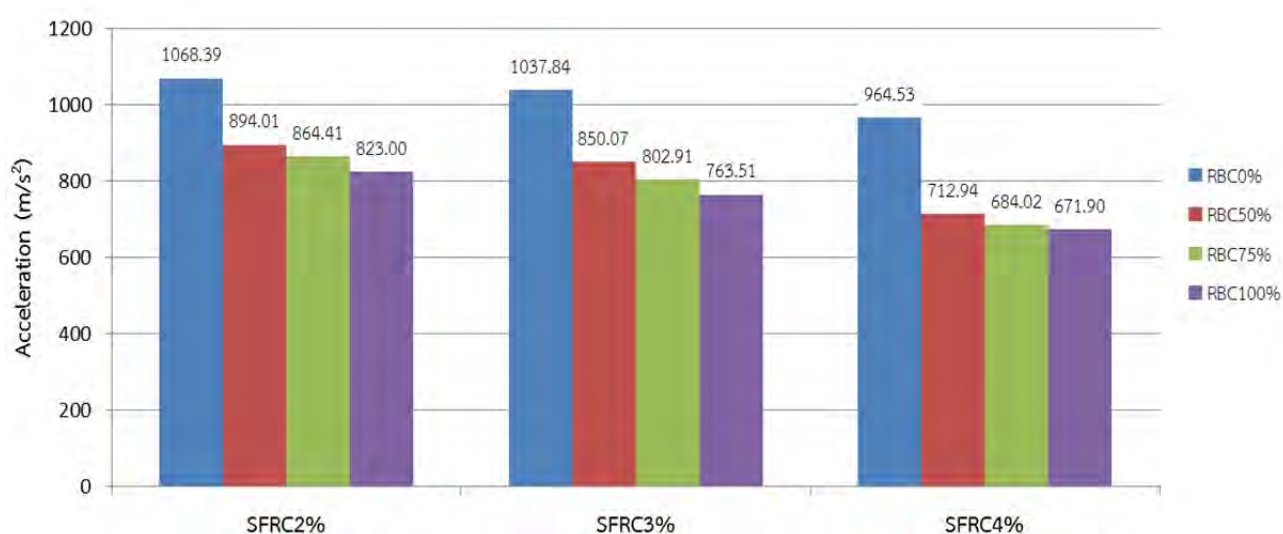
รูปที่ 4.15 อัตราเร่งของแผ่นคอนกรีตภายใต้แรงกระแทกของกระสุนขนาด 9 มม.
