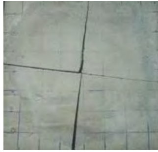
รูปที่ 4.21 พฤติกรรมการรับแรงและรูปแบบการวิบัติของแผ่นคอนกรีตล้วนแบบชั้นเดียว
