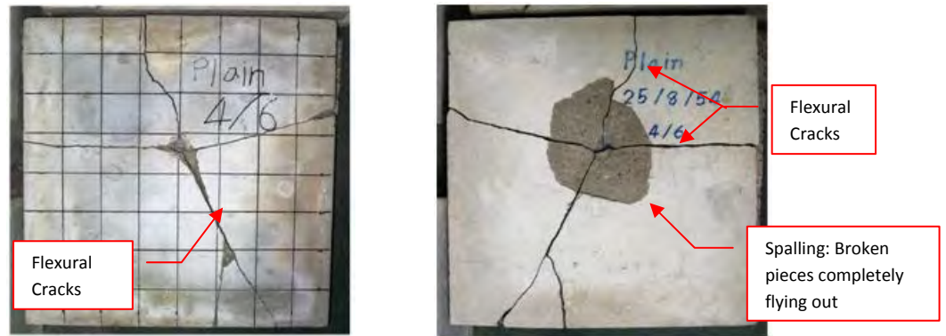
รูปที่ 4.1 การวิบัติของแผ่นคอนกรีตล้วนแบบชั้นเดียว
