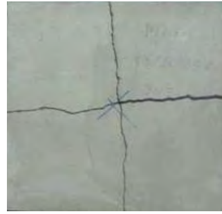
รูปที่ 4.21 พฤติกรรมการรับแรงและรูปแบบการวิบัติของแผ่นคอนกรีตล้วนแบบชั้นเดียว
