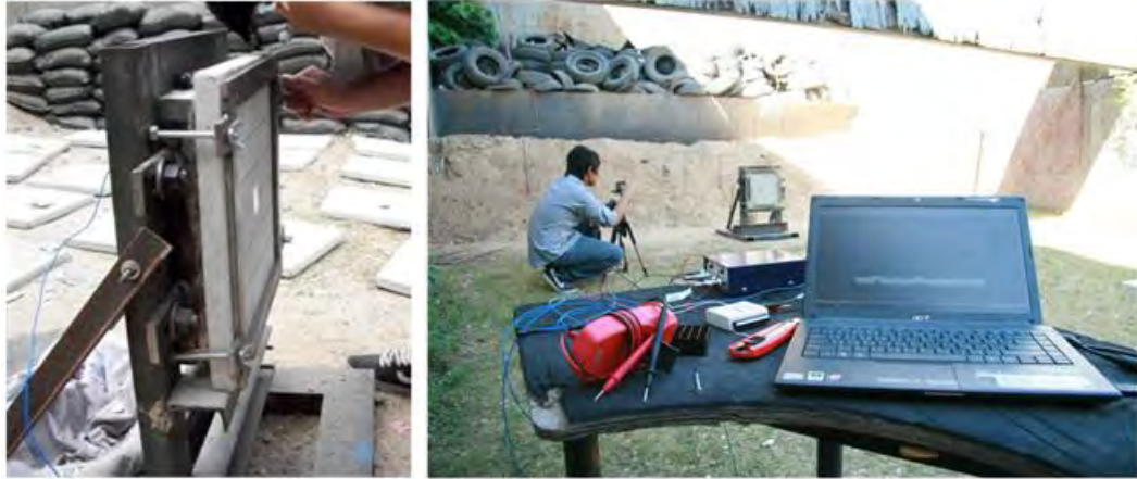
รูปที่ 3.5 ภาพแสดงการติดตั้งแผ่นคอนกรีตก่อนทำการทดสอบ
