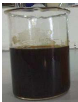
ภาพที่ 2.1 กลีเซอรอลดิบที่เกิดจากกระบวนการผลิตไบโอดีเซลโดยใช้น้ำมันพืชหรือไขมันสัตว์ที่ผ่านการใช้งานแล้วเป็นสารตั้งต้น
