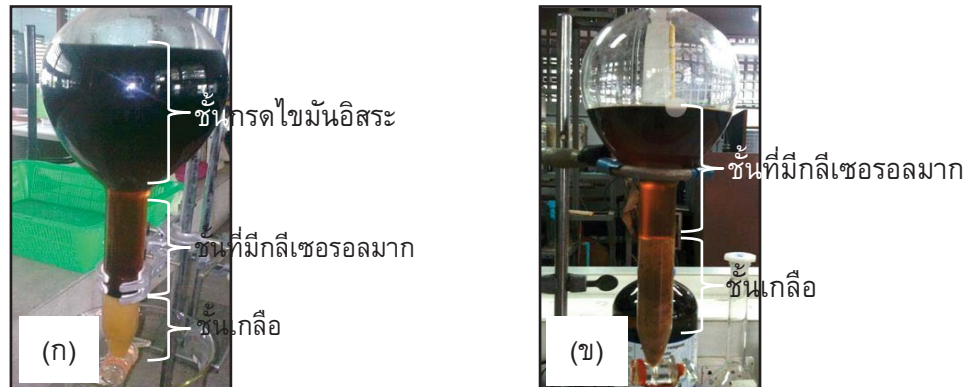
ภาพที่ 2.3 ลักษณะการแยกชั้นของสารละลายกลีเซอรอลดิบที่ทำการปรับสภาพเบื้องต้นด้วย (ก) กรดฟอสฟอริกเข้มข้น และตามด้วย (ข) โซเดียมไฮดรอกไซด์เข้มข้น 12.5 โมลต่อลิตร
