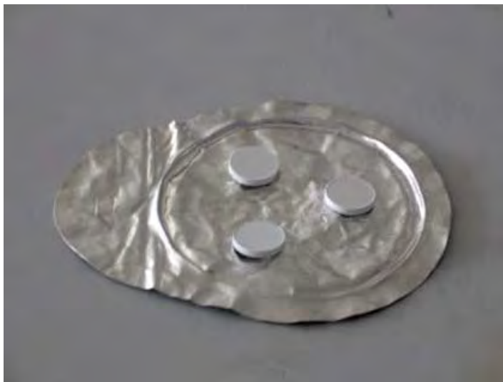
รูป 3.13 ลักษณะการวางชิ้นงานตัวอย่างบนฝาของถ้วยหลอมแพลตินัม
