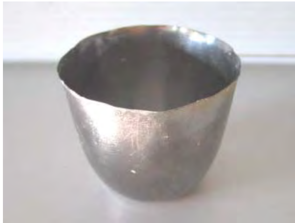
รูป 3.20 ถ้วยหลอมทองคำขาวหรือถ้วยหลอมแพลตตินัม(Platinum crucible)
