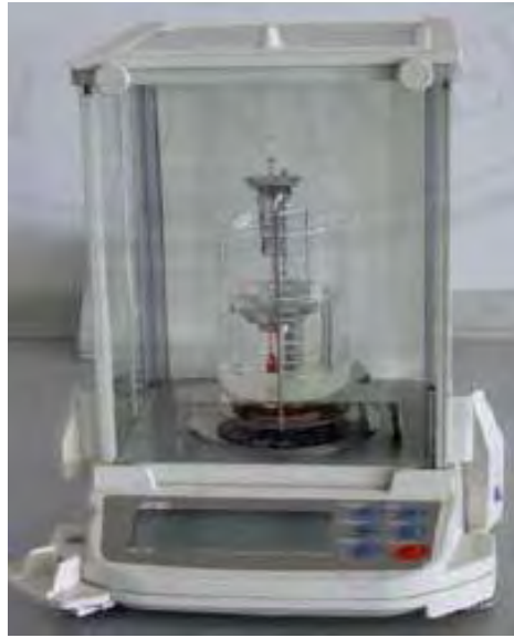
รูป 3.23 เครื่องชั่งระบบดิจิตอลสำหรับวัดความหนาแน่น
