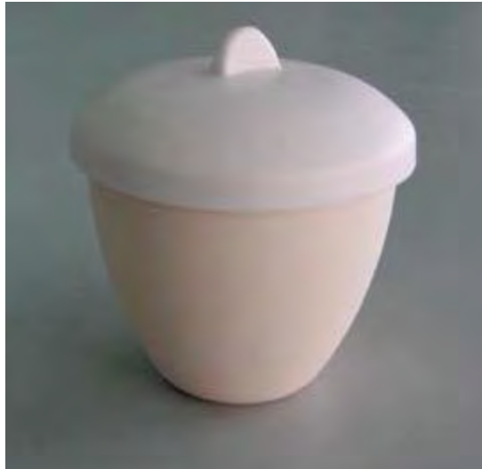
รูป 3.7 ถ้วยหลอมอะลูมินา (alumina crucible)
