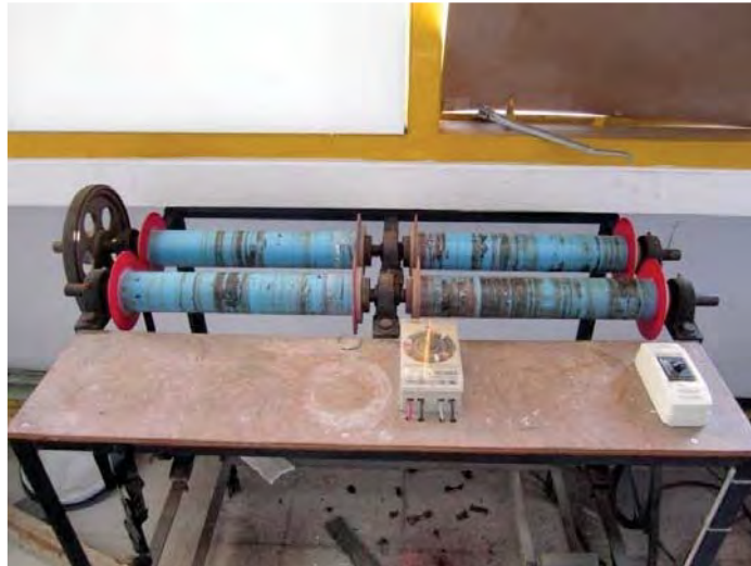
รูป 3.17 เครื่องบดผสมด้วยลูกบอล
