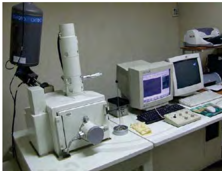
รูป 3.27 กล้องจุลทรรศน์อิเล็กตรอนแบบส่องกราด (SEM)
