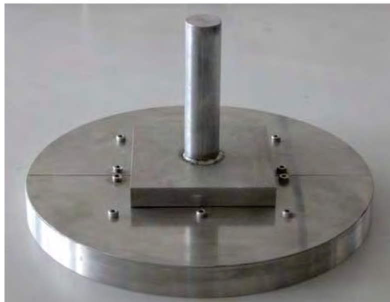
รูป 3.8 แผ่นเหล็กกล้าไร้สนิม (stainless steel plate) สำหรับกดทับน้ำแก้ว
