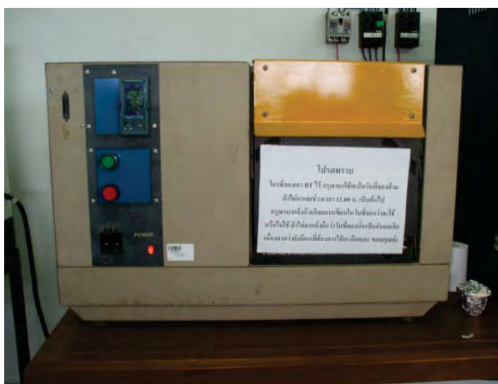
รูป 3.14 เตาเผาไฟฟ้า (furnace)
