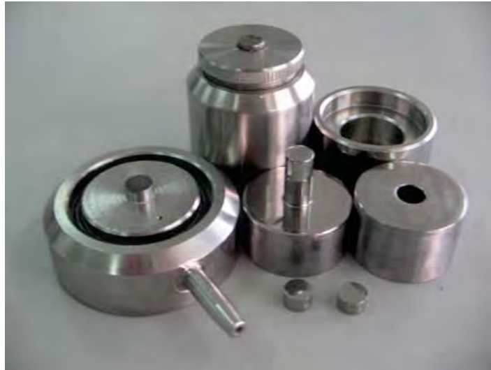
รูป 3.11 แม่พิมพ์ (punch and die) ขนาดเส้นผ่านศูนย์กลาง 1.0 เซนติเมตร
