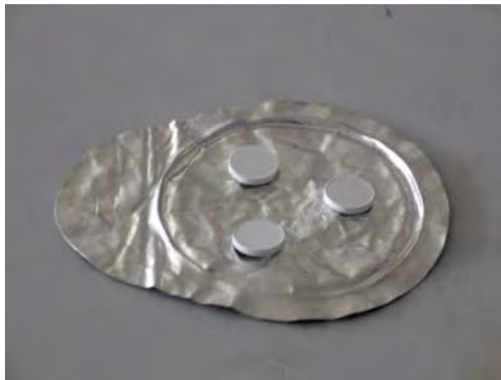
รูป 3.13 ลักษณะการวางชิ้นงานตัวอย่างบนฝาของถ้วยหลอมแพลตินัม
