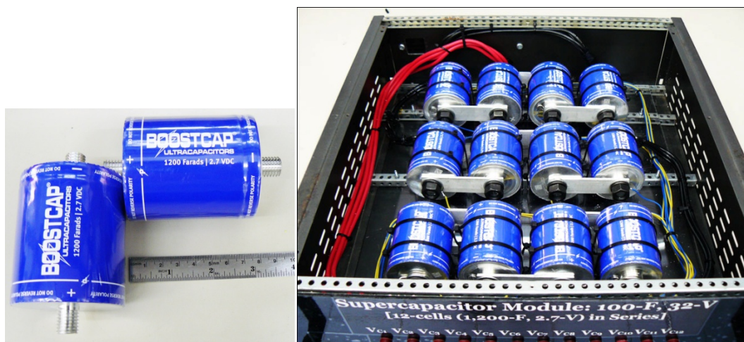
ภาพที่ 1-27 ซูเปอร์คาปาซิเตอร์ของบริษัท Maxwell (เรียกว่า Booscap) 1 เซลล์ และโมดูลที่ BCAP1200 ต่ออนุกรมกัน 12 ตัว
