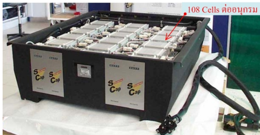
ภาพที่ 1-26 ซูเปอร์คาปาซิเตอร์ของบริษัท SAFT โมดูลขนาดใหญ่ 108 ตัว ต่ออนุกรมกัน
