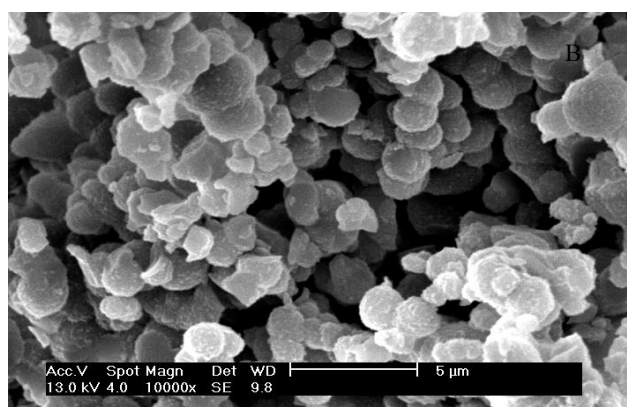
รูปที่ 21 แสดงภาพถ่ายจาก SEM ของโมโนลิทซิลิกาอินทรีย์ C18 ที่สังเคราะห์ภายในช่องของระบบการไหลขนาดเล็กที่ทำจาก PDMS
