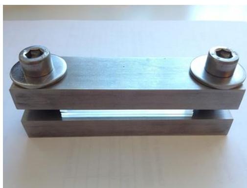
รูปที่ 9 แท่นโลหะเพื่อการทำการประกบแผ่นชิ้นงาน PTFE
