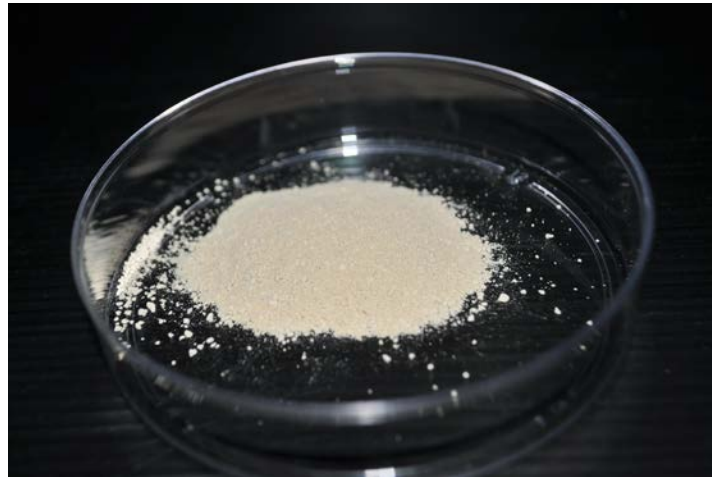
รูปที่ 3 ลักษณะทางกายภาพของอนุภาคไมโครสเฟียร์จากโปรตีนกาวไหมเซรีซินและไคโตซานที่ผลิตด้วยวิธี coacervation เมื่อมองด้วยตาเปล่า
