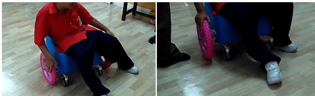
รูปที่ 4.9 ปัญหาเมื่อขาเด็กขัดการทำงานของล้อ
