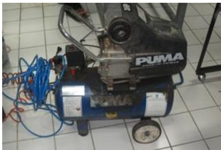
รูปที่ ก.6 ปั๊มลมโรตารี PUMA รุ่น XM-2525 Puma 3Hp ขนาดถังลม 260x700 แรงอัด 8 bar แรงลม 260 L/min
