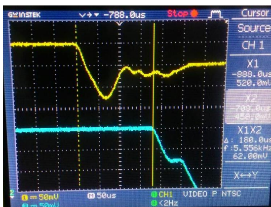
รูปที่ ก.12 สัญญาณไฟฟ้าที่ได้จาก Digital Oscilloscope ในการวัดความเร็วของลำพุ่ง
