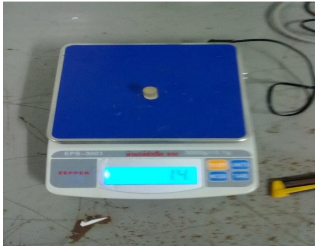
รูปที่ ก.7 เครื่องชั่งดิจิตอล รุ่น GPS-3001 พิกัดกำลัง 3000 g ความละเอียด 0.1 g
