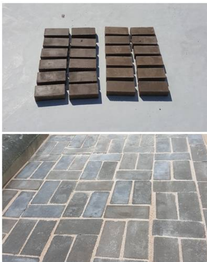
รูปที่ 4.16 ตัวอย่างอิฐจีโอโพลิเมอร์ที่บ่มด้วยอากาศร้อน และทางเดินสาธิตจากอิฐจีโอโพลิเมอร์
