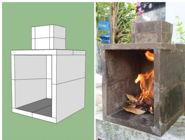
รูปที่ 4.25 ตัวอย่างเตาเผาจากอิฐจีโอโพลิเมอร์ที่บ่มด้วยอากาศร้อน
