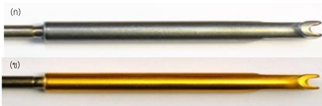
รูปที่ 4.9 ตะขอบน (ก) ก่อนการเคลือบแข็ง (ข) หลังการเคลือบแข็งด้วย TIN
