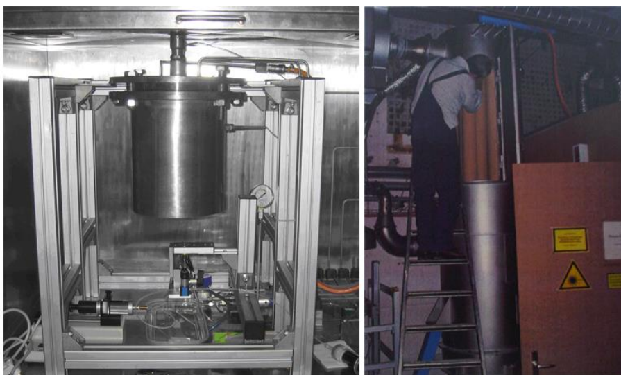
รูป 1.3 เครื่องผลิตวัสดุนาโนความบริสุทธิ์สูงเฟลมสเปรย์ไพโรลิซิสจัดตั้งที่คณะวิทยาศาสตร์ มหาวิทยาลัย เชียงใหม่ (ซ้าย) และการผลิตขนาดใหญ่ที่ประเทศสวีตเซอร์แลนด์ เพื่อผลิตวัสดุนาโนปริมาณสูงในอุตสาหกรรมระดับใหญ่ในประเทศสวีตเซอร์แลนด์และประเทศเยอรมนี (ขวา)
