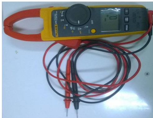
รูปที่ 20 Clamp meter
