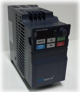
รูปที่ 17 Inverter control pump
