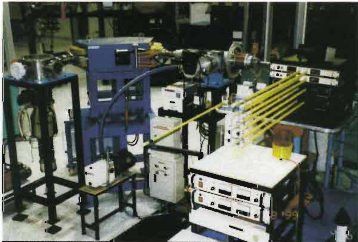
รูปที่ 3.5 เครื่องยิงไอออนเอนกประสงค์ ION-CMU3 (ก) รายละเอียด (ข) รูปภาพ
