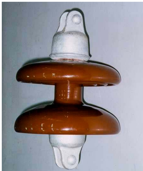
อุปกรณ์ศึกษาวิจัยผลของแรงดันอิมพัลส์น้ำหนักขึ้นต่อลูกถ้วยฉนวนพอร์ซเลน
