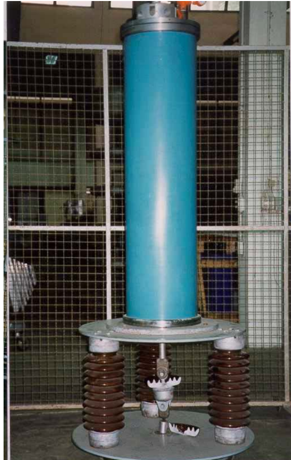
รูปที่ 4-3 ภาพถ่ายการติดตั้งลูกถ้วยแขวนเพื่อทดสอบด้วยแรงดันอิมพัลส์น้ำหนักคลื่นชั้น ก่อนเจาะทะลุและหลังการเจาะทะลุ
