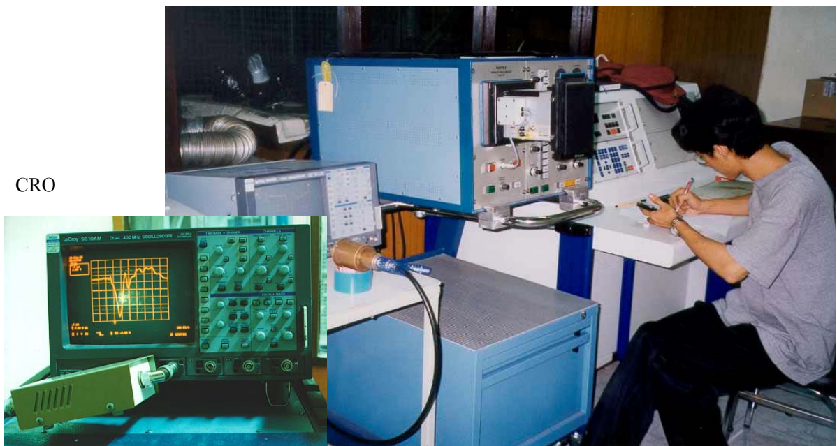
รูปที่ 4-1 ภาพถ่ายเครื่องกำเนิดแรงดันอิมพัลส์หน้าคลื่นขั้นทดสอบการเจาะทะลุ ของลูกถ้วยนวนพอร์ซเลน พร้อมอุปกรณ์วัดและควบคุม [16]
