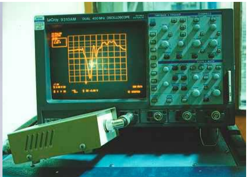
อุปกรณ์ศึกษาวิจัยผลของแรงดันอิมพัลส์น้ำหนักขึ้นต่อลูกถ้วยฉนวนพอร์ซเลน
