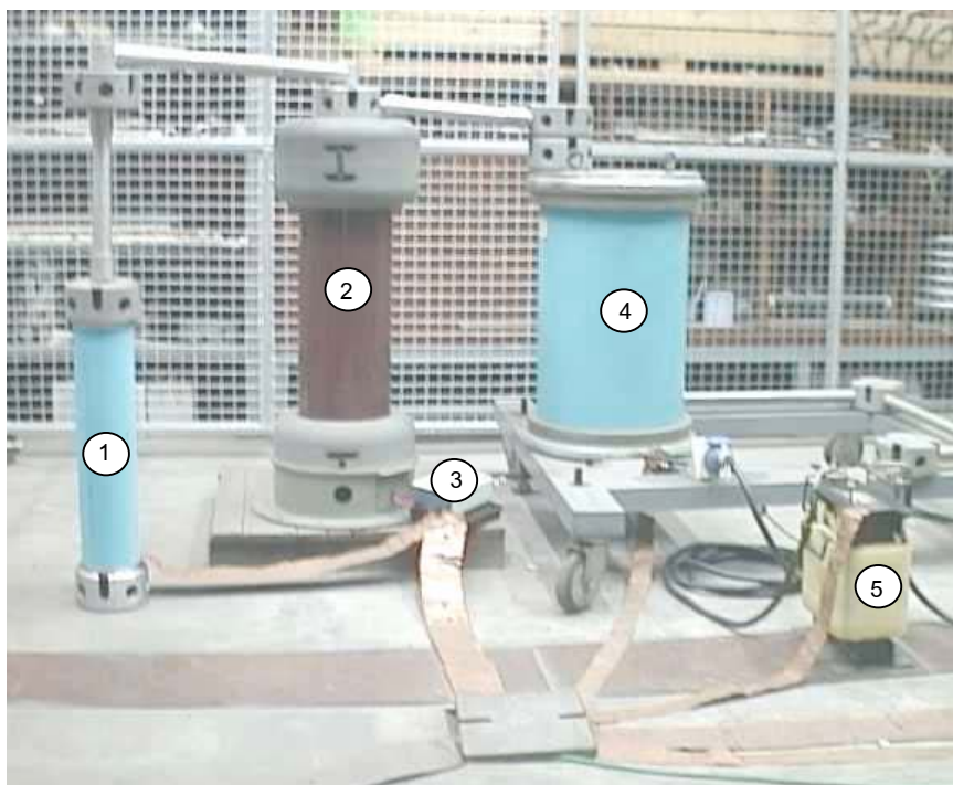
รูปที่ 4.5 วงจรที่ใช้ในการทดสอบตัวเก็บประจุแรงสูง
