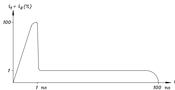
รูปที่ 2.4 แสดงลักษณะรูปร่างของกระแส PD ในทางทฤษฎีสำหรับแก๊สเล็กๆ
