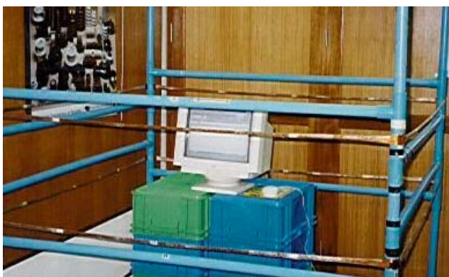
รูปที่ 4-9 การติดตั้งจอยคอมพิวเตอร์ทดสอบในขดลวด Helmholtz coil
