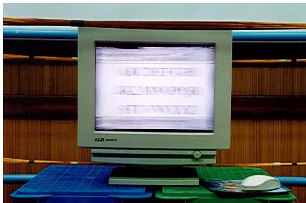
รูปที่ 5-9 ตัวเลขและตัวอักษรบนหน้าจอคอมพิวเตอร์สั่นเมื่อถูกรบกวนโดยสนามแม่เหล็ก
