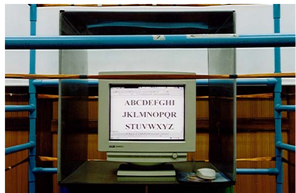
รูปที่ 5-10 คอมพิวเตอร์ติดตั้งในกล่องชิลด์
