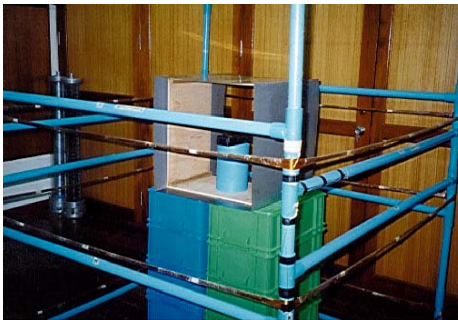
รูปที่ 5-4 การทดสอบการปิดกั้นสนามแม่เหล็กของกล่องโลหะซิลิกอนที่ละชั้น
