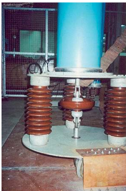
รูปที่ 3-1 การติดตั้งลูกถ้วยแขวนคอตันชั้นเดียวเพื่อทดสอบความคงทนต่อการเจาะทะลุด้วยแรงดันอิมพัลส์หน้าคลื่นชัน
