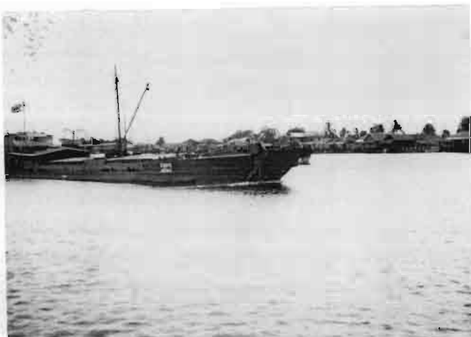
ภาพที่ 38 เรือยนต์ตัวเรือเป็นเหล็ก ชื่อเรือพายูทะเล เป็นเรือฟรีเกตที่ดัดแปลงมาเป็นบรรจุข้าวในสมัยสงครามครั้งที่ 2 เป็นเรือขนาดกลางที่สามารถแล่นเข้ามาเทียบท่ารับสินค้าถึงโรงสีในแม่น้ำปากพนังได้ สามารถบรรทุกข้าวได้ถึง 300-400 กระสอบ
