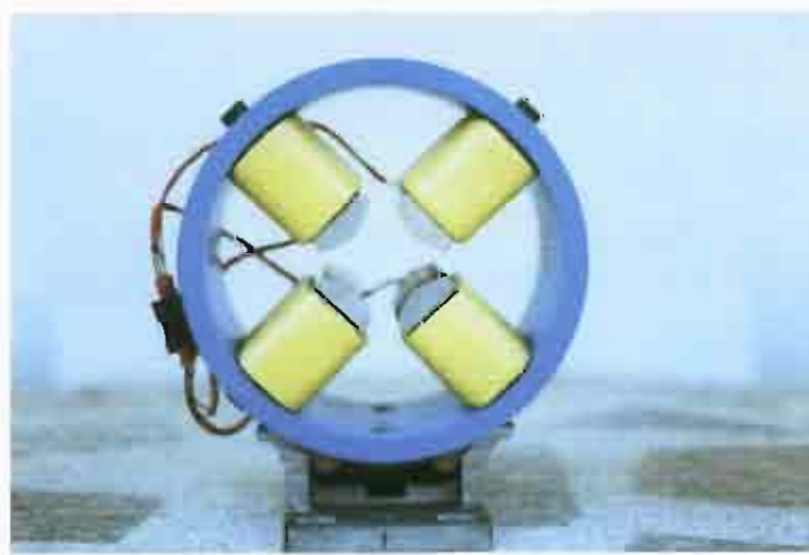
รูปที่ 3.19 แม่เหล็กสี่ขั้วต้นแบบสำหรับโฟกัสลำอิเล็กตรอนที่มีค่าพลังงาน 3 ล้านอิเล็กตรอนโวลต์
