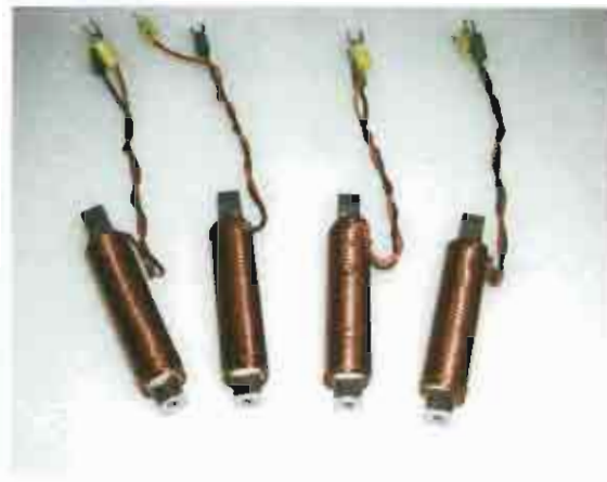
รูปที่ 3.25 ขดลวดที่พันรอบแกนเหล็กเหล็ยม แต่ละขดของ Steering Magnet
