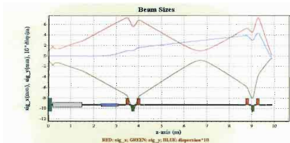
รูปที่ 3.43 แผนภาพแสดงแนวทางการเคลื่อนที่ของลำไอออนฮีเลียมภายใต้อิทธิพลของสนามไฟฟ้าและ สนามแม่เหล็ก โดยเส้นสีแดง แสดงขนาดของลำไอออนตามแนวแกน x และเส้นสีเขียวแสดงขนาดของลำไอออนตามแกน y เส้นสีน้ำเงิน บอกถึงการกระจายตัวของพลังงานของลำไอออน
