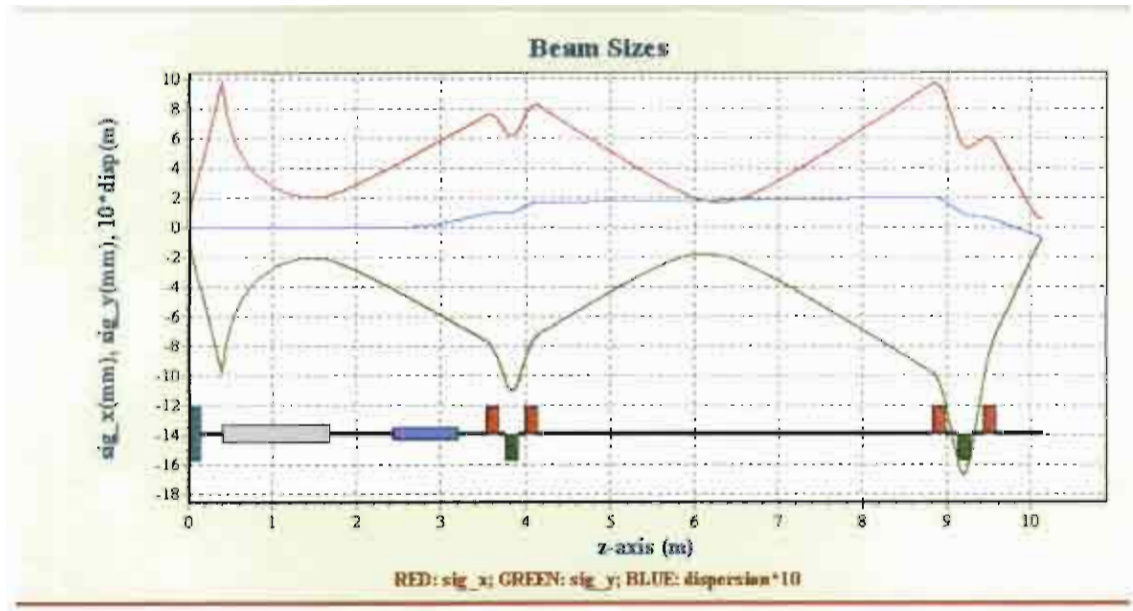
รูปที่ 3.42 แผนภาพแสดงแนวทางการเคลื่อนที่ของลำไอออนอาร์กอนภายใต้อิทธิพลของสนามไฟฟ้าและสนามแม่เหล็ก โดยเส้นสีแดงแสดงขนาดของลำไอออนตามด้านแกน x และเส้นสีเขียวแสดงขนาดของลำไอออนตามด้านแกน y โดยที่เส้นสีน้ำเงิน
