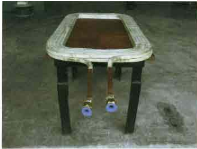
รูปที่ 3.14 แสดงขดลวดทองแดง 1 double pancake
