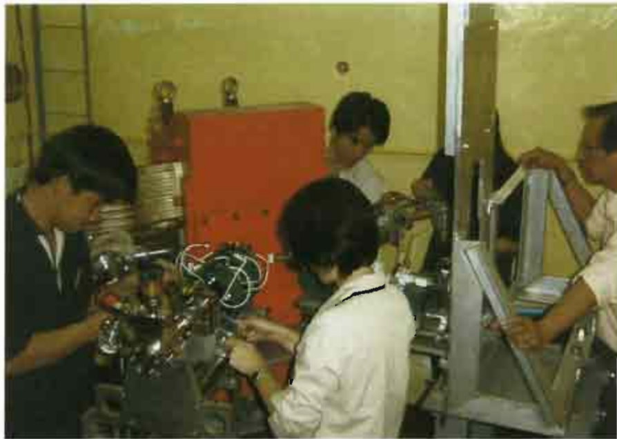
รูปที่ 3.29 การติดตั้งระบบลำเลียง และระบบตรวจวัดลำอิเล็กตรอน
