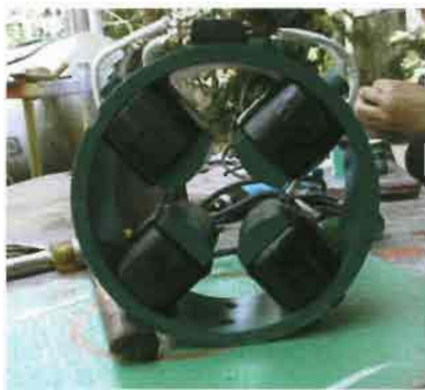
รูปที่ 3.20 แม่เหล็กสี่ขั้วสำหรับการ โฟกัสลำอิเล็กตรอน ที่มีค่าพลังงาน 2.7 ล้านอิเล็กตรอนโวลต์
