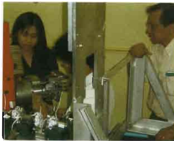
รูปที่ 3.28 การติดตั้ง energy slit
