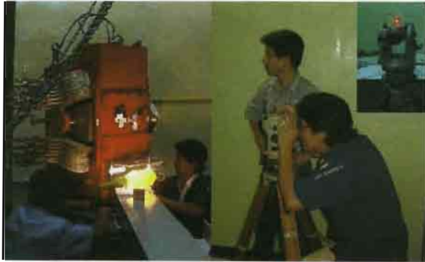
รูปที่ 3.27 การติดตั้ง chamber สำหรับแม่เหล็กแบบแอลฟาโดยใช้ Theodelite และ alignment laser
