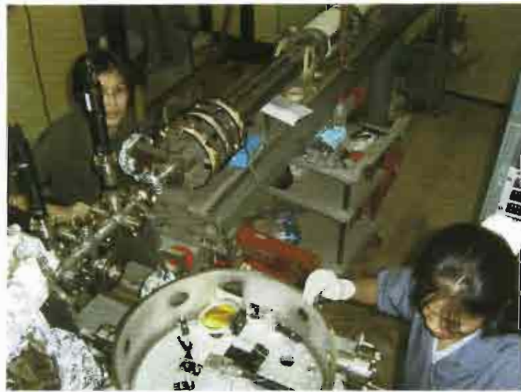
รูปที่ 3.32 การติดตั้งระบบตรวจวัดห้วงอิเล็กทรอนิกส์ในเรือนเฟมโตวินาที
