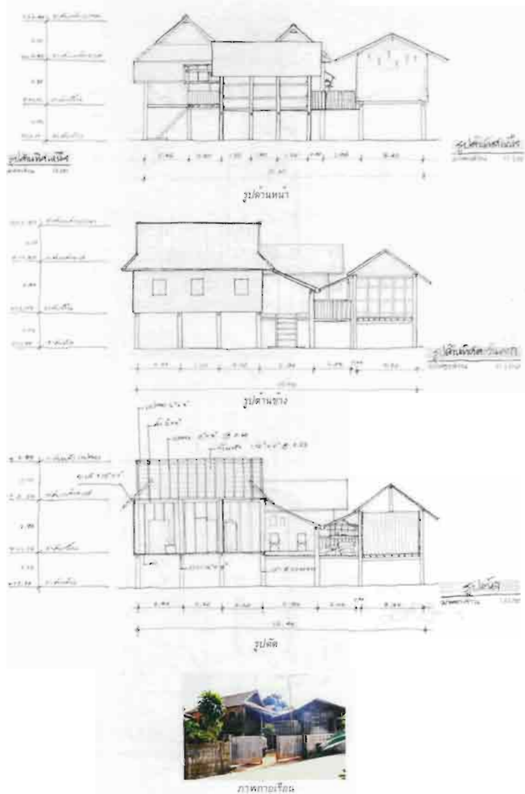
ภาพที่ 4-52.2 ตัวอย่างรูปด้าน รูปตัด และภาพถ่ายเรือน (ประเภทเรือนแบบมีเรือนขวาง) ที่แสดงการจัดพื้นที่ใช้สอยภายในเรือนพื้นที่ ๕ ห้องนอน ๕ ห้องน้ำ (เรือนของนายสม พลสมาน พุ่มบ้านแพน)
