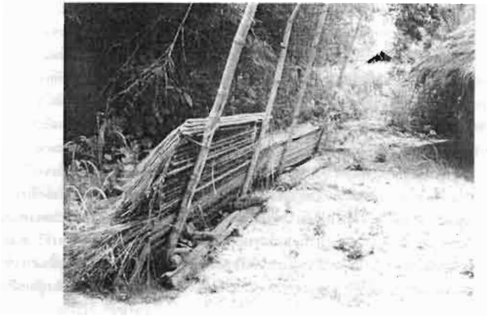
ภาพที่ 8-12 แผงหลังคาหญ้าที่ถูกจัดเตรียมไว้รอบเปลี่ยนหลังคาคราวถัดไป ซึ่งเป็นวัสดุที่ได้จากสวน หญ้าครอบบริเวณเรือนไทพวน
