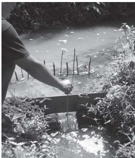
แก่งฝายใช้ไม้วัดระดับความลึกของปากเหมือง
