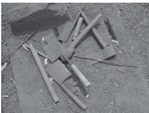
เครื่องมือขุดศิลาแลงที่ทำขึ้นเฉพาะ ต้องมีความทนทานเป็นพิเศษ
