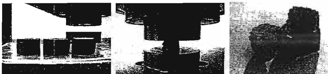
รูปที่ 7. (A) เชื้อเพลิงแก๊สแข็งก่อนการทดสอบ (B) เชื้อเพลิงแก๊สแข็งขณะทดสอบความเค้นอัดด้วย UTM (C) ชิ้นงานที่ผ่านการทดสอบแล้ว
