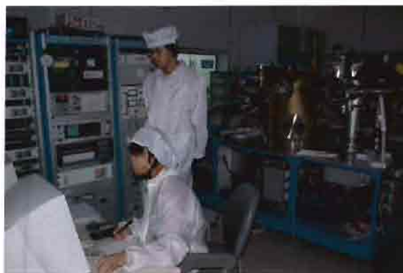
รูปที่ 10 เครื่องปลูกชั้นผลึกด้วยลำโมเลกุลที่ใช้ในการศึกษาวิจัยโครงสร้างควอนตัมคอต แบบต่าง ๆ สำหรับงานด้านนาโนอิเล็กทรอนิกส์และนาโนโฟโตนิกส์
