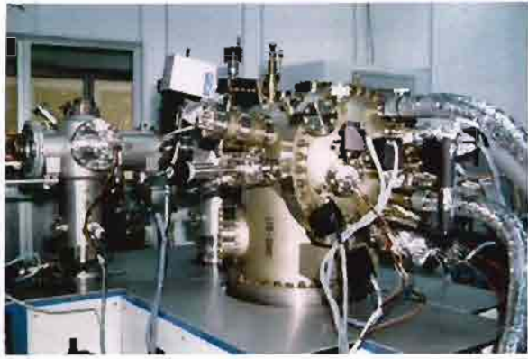
รูปที่ 1 เครื่องปลูกชั้นผลึกด้วยลำโมเลกุลภายใต้สภาพสุญญากาศที่เชื่อมที่ใช้ในงานทดลอง สร้างควอนตัมดอตที่ คณะวิชาฯ จุฬาฯ
