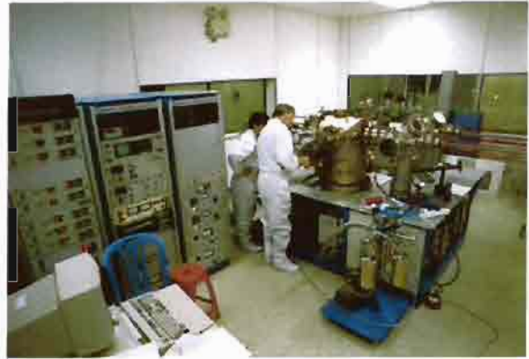
รูปที่ 1 เครื่องปลูกชั้นผลึกด้วยลำโมเลกุลภายใต้สภาพสุญญากาศที่เชื่อมที่ใช้ในงานทดลอง สร้างควอนตัมดอตที่ คณะวิชาฯ จุฬาฯ
