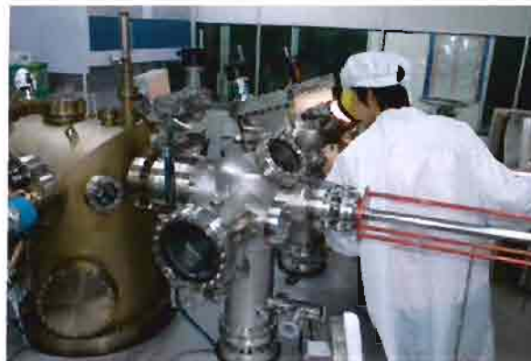
รูปที่ 10 เครื่องปลูกชั้นผลึกด้วยลำโมเลกุลที่ใช้ในการศึกษาวิจัยโครงสร้างควอนตัมคอต แบบต่าง ๆ สำหรับงานด้านนาโนอิเล็กทรอนิกส์และนาโนโฟโตนิกส์
