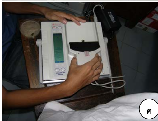
ภาพ ก และ ข) การวัดพื้นที่ใบโดยใช้กระดาษกราฟ ค และ ง) การวัดพื้นที่ใบโดยใช้ เครื่องวัดพื้นที่ใบที่มีราคาประมาณ 3 แสนบาท
