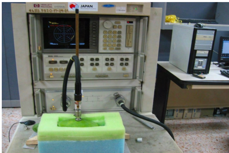
รูปที่ 5 การทดสอบค่า \epsilon' และ \epsilon'' ของมะม่วง
