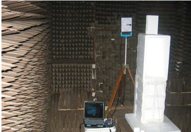
รูปที่ 34 รูปถ่ายการทดสอบระยะทางการติดต่อสื่อสารระหว่างเครื่องอ่านข้อมูลกับแท็กที่ไกลที่สุด ( R_{max} ) เมื่อแท็กติดบนอิฐมวลเบา
