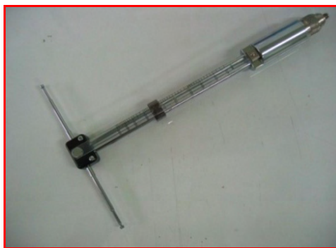
รูปที่ 3 สายอากาศสำหรับเครื่องอ่านข้อมูลชนิดไดโพล [12]
