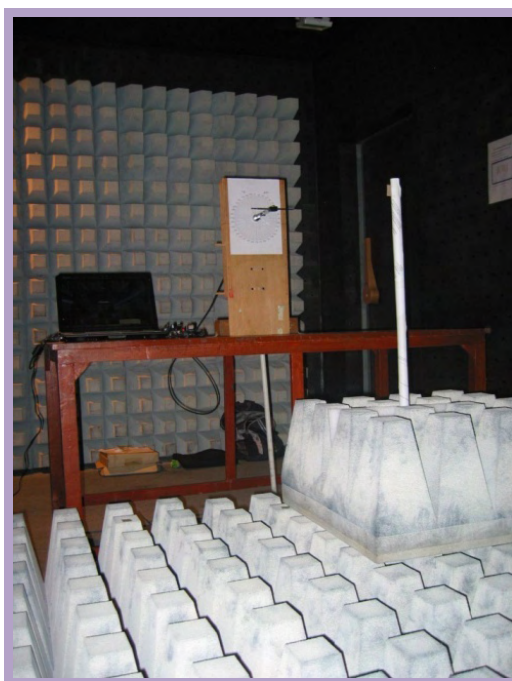
รูปที่ 1 การทดสอบในห้องไร้การสะท้อนที่ศูนย์ทดสอบมาตรฐาน PTEC [13]
