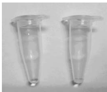
ภาพที่ 13 ผลการทดสอบตัวอย่างที่พบการตกตะกอนของอนุภาคเงินนาโนด้วย sodium borohydride ไม่พบการเปลี่ยนแปลงของสารละลายเป็นสีเหลือง
