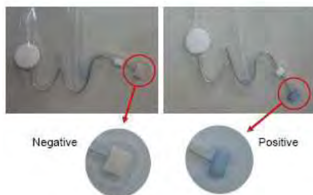
ภาพที่ 6 ผลการตรวจพบชิปแสดงการตกตะกอนของสารละลายเงินนาโนเพลทสีฟ้าเป็นสารละลายสีเหลืองอ่อน-ใสบนกระดาษในส่วน detection pad ในกรณีที่ไม่มีดีเอ็นเอเป้าหมาย (ซ้าย) เปรียบเทียบกับการไม่ตกตะกอนและคงสีฟ้าในกรณีที่มีดีเอ็นเอเป้าหมาย (ขวา)
