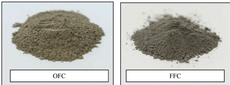
รูปที่ 3.4 กากแคลเซียมคาร์ไบด์ผสมร่วมกับเถ้าถ่านหินที่ไม่ได้บดและแบบบดละเอียด
