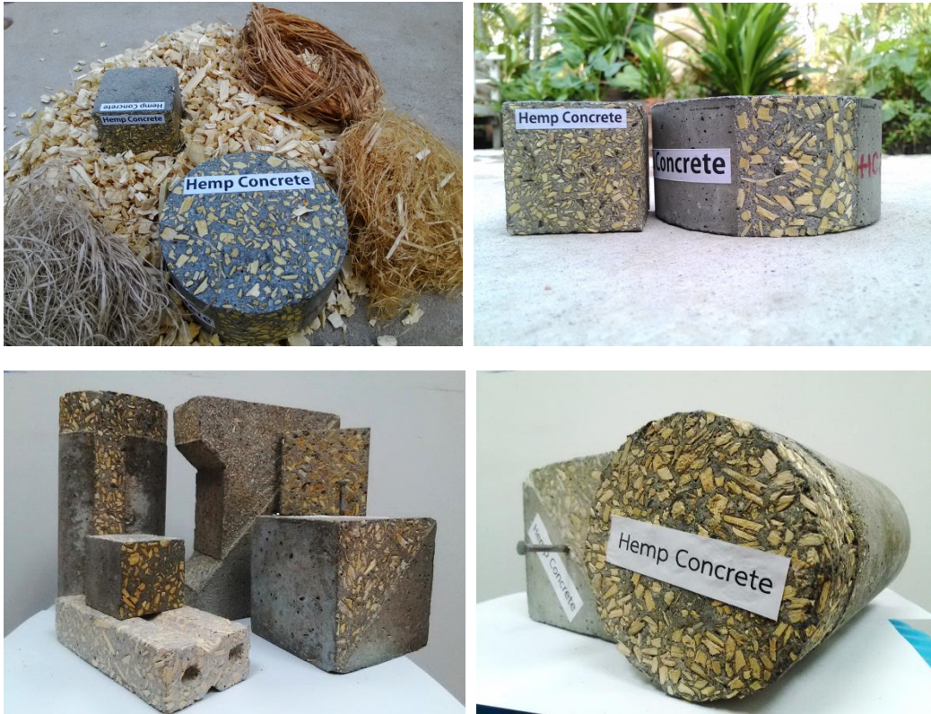
รูปที่ 2.9 การกระจายตัวของแกนเฮมพ์ในเนื้อคอนกรีต
