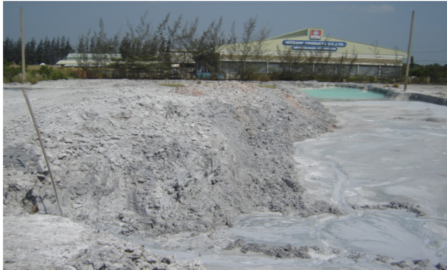
รูปที่ 3.2 พื้นที่ทิ้งกากแคลเซียมคาร์ไบด์ของโรงงานผลิตก๊าซอะเซทิลีน
