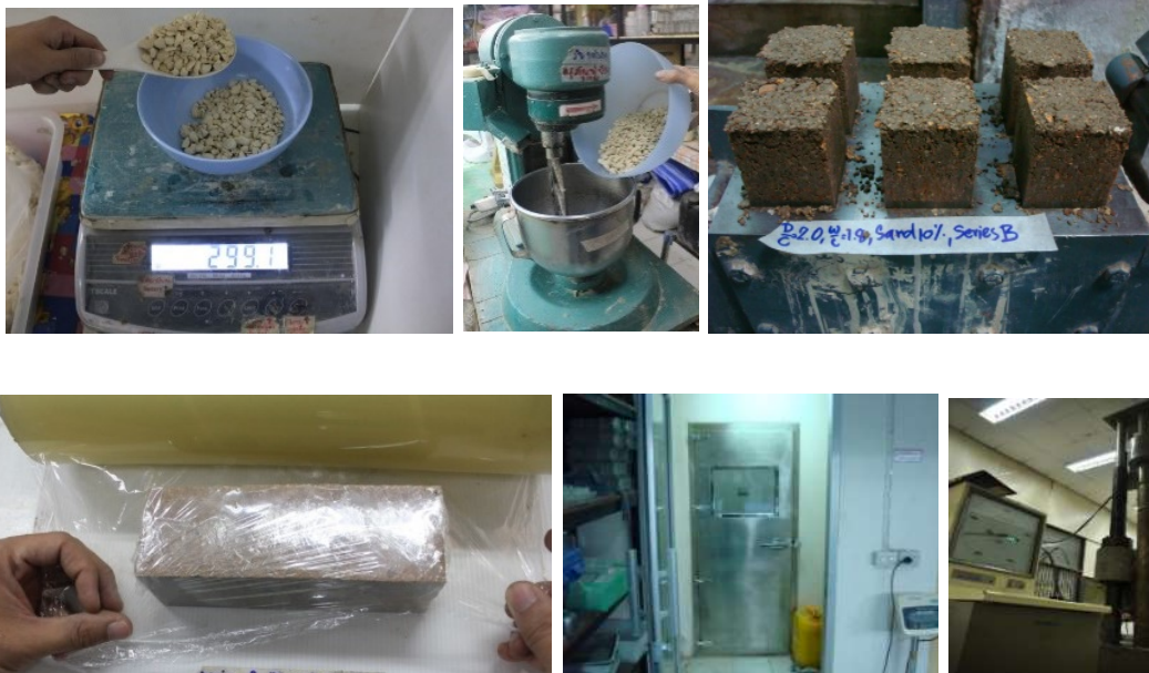
รูปที่ 11.1 การผลิตคอนกรีตมวลเบาที่ผสมไดอะตอมไมต์เผา
