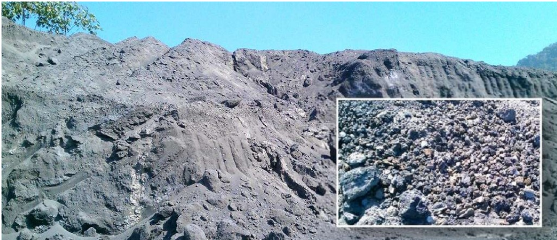
รูปที่ 4.6 ที่กองเก็บและลักษณะเถ้าหนักที่ได้จากโรงไฟฟ้าแม่เมาะ จังหวัดลำปาง
