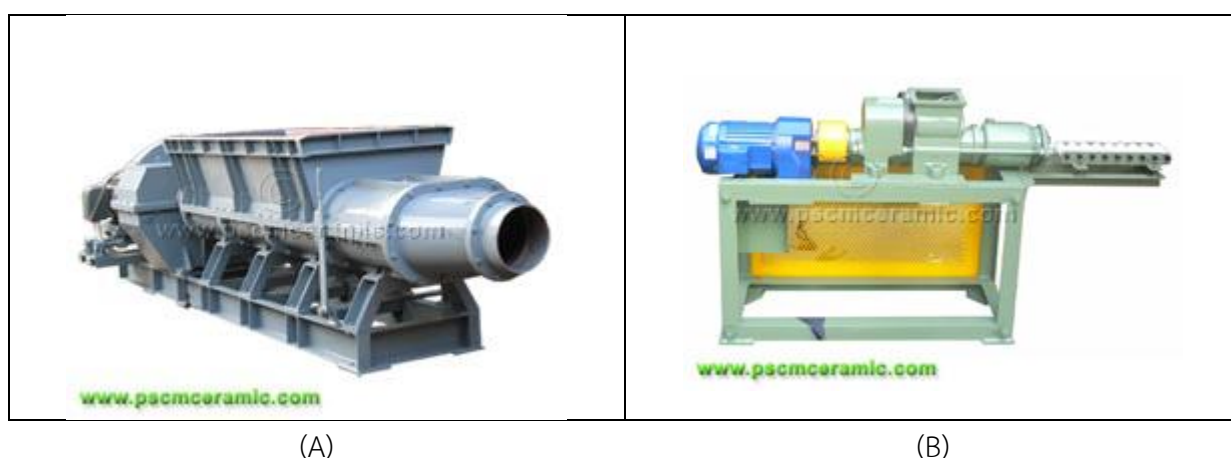
ภาพประกอบ 4.3 รูป (A) เครื่องผสมดิน และ รูป (B) เครื่องอัดดินแท่ง ที่มา: http://www.pscmceramic.com
