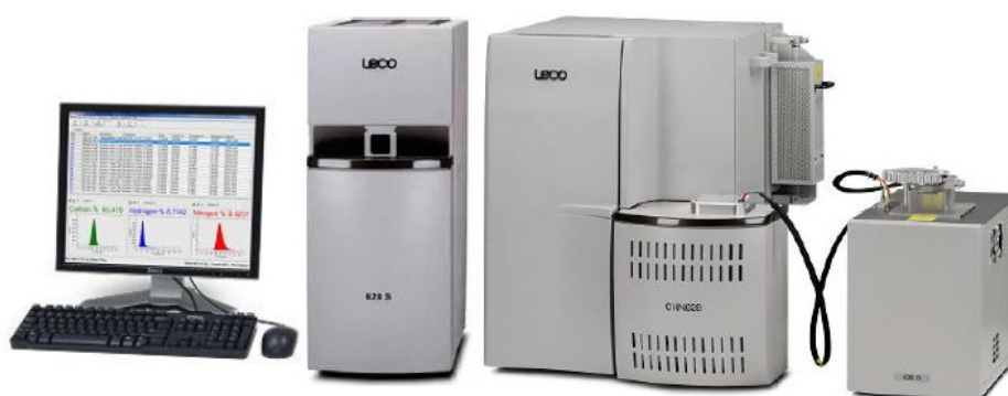
ภาพที่ 21 เครื่องวิเคราะห์ธาตุ C, H, N, S รุ่น CHNS-628
