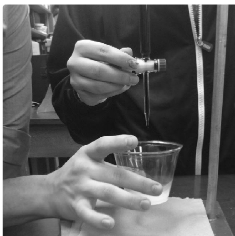
ภาพที่ 3.46 อุปกรณ์ในการวัดการทำงานของ Catalase โดยวิธี Titrimetric
