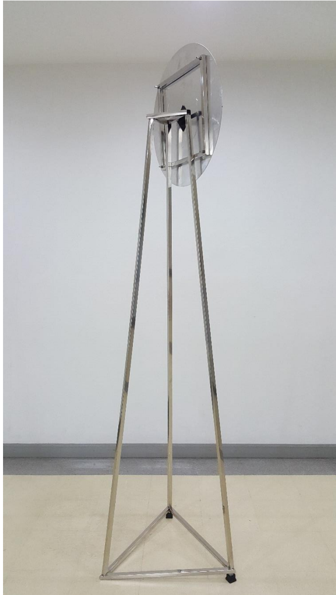
รูปที่ 4.1-18 ต้นแบบป้ายสัญลักษณ์ blueBLE SignPost ด้านข้าง
