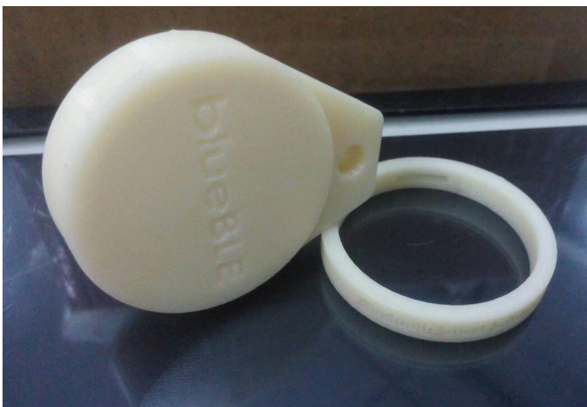
รูปที่ 2.1-3 blueBLE tag ตัวแรกจากห้องทดลอง สร้างด้วยเครื่องพิมพ์สามมิติ
