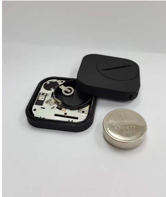
รูปที่ 4.1-16 ลักษณะภายในของอุปกรณ์บีคอน
