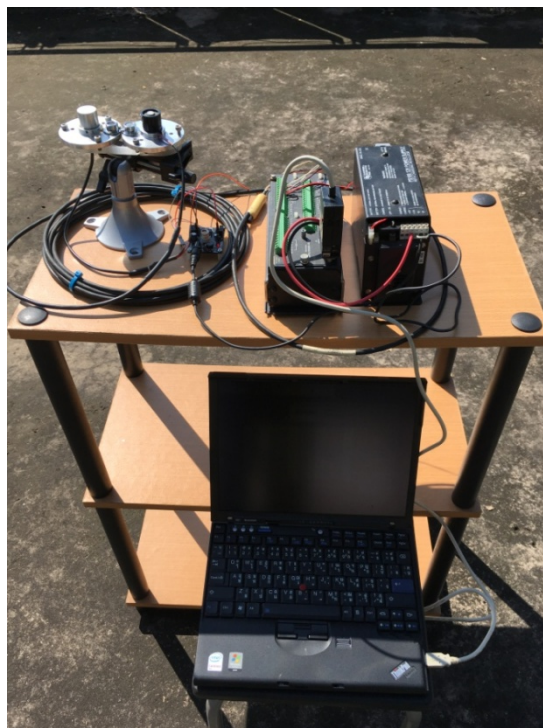
ภาพที่ 8 เทียบค่าพลังแสงอาทิตย์โดยใช้ Li-Cor LI200X pyranometer เป็นอุปกรณ์อ้างอิง โดยต่อเซ็นเซอร์ทั้ง 2 เข้ากับเครื่องบันทึกข้อมูล Campbell CR10X และอ่านค่าการวัดจากเครื่อง PC แบบเวลาจริง
